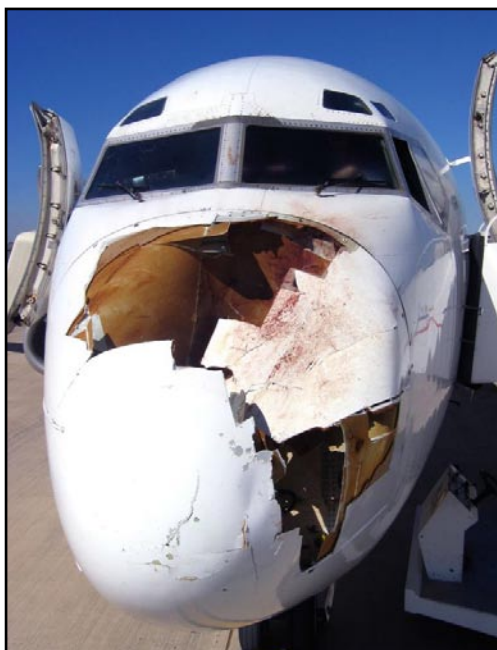
Повреждение носовой части самолёта в результате столкновения с орлом. Фото Д. Дъхерб
